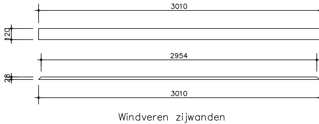
Windveren en dakbalken
